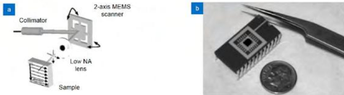
图 3. 二维 MEMS 扫描镜 [50] 。(a) 扫描示意图; (b) 封装后的 MEMS 扫描镜
