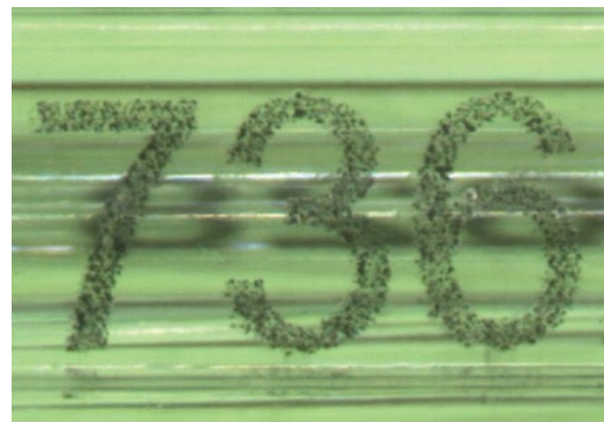
图3、聚碳酸酯材料的表面标记。字母高度为2毫米。
